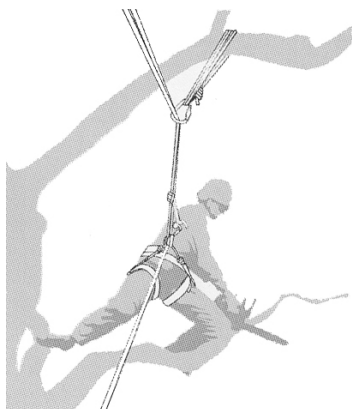
Figura B.3 - Ejemplo de redireccionamiento de la línea principal a través de un punto de anclaje suplementario
