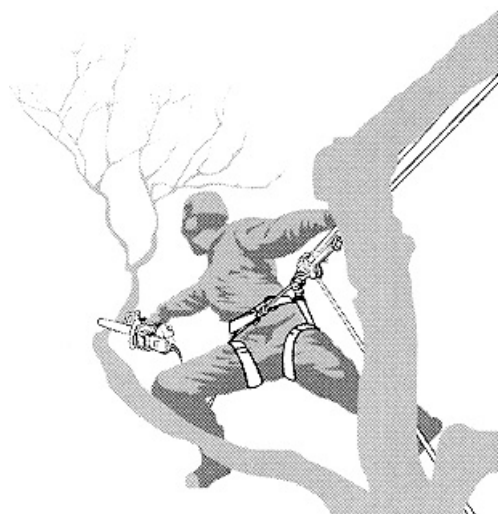
Figura B.5 - Ejemplo de uso de una motosierra con una sola mano
