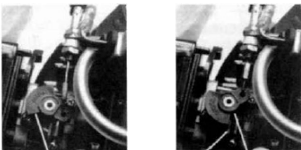
Position Gashebel auf Maximum
